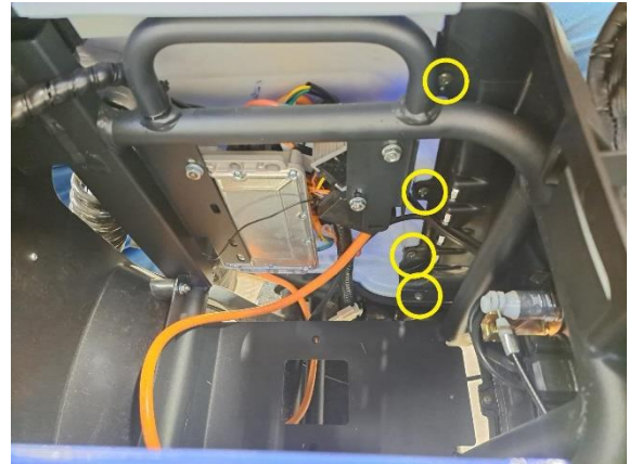
Irrota istuimen vasemmanpuoleisen alasivumuovin kiinnitysruuvit (ristipäämeisseli ph2).
