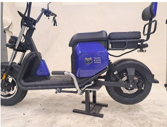
Nosta laitteen takaosa korokkeelle.
