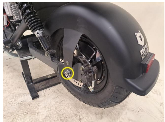
Irrota moottorin kiinnityspultit molemmin puolin (kuusiokoloavain 10 mm).
